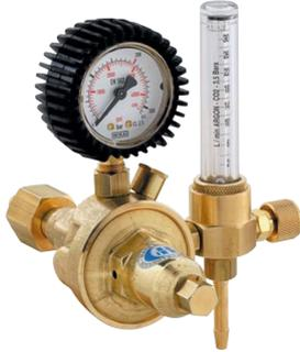
Détendeurs débitlitres tarés à 3,5 bars avec colonne (rotamètre) graduée de 0 à 15 ou 30 l/mn. La lecture de la colonne permet une très bonne précision du débit de gaz idéal pour le soudage TIG des inox et aluminium. Existe en version OX en 7 et 15 l/mn.
